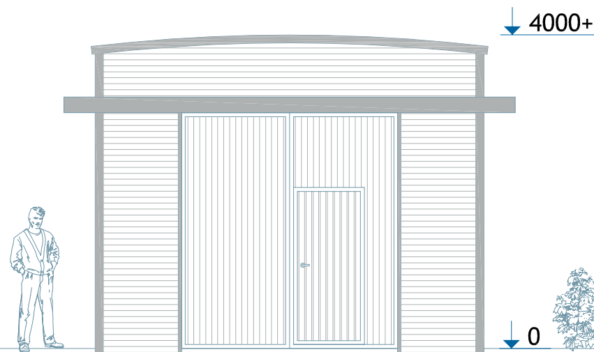
Sliding door 2750x3000 Sliding on outside Schiebetor, Außenlaufend / Schuifdeur, buitenschuivend
